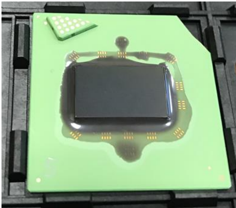
Рис. 2. Разрушение подложки из LTCC керамики
