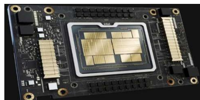
Рис. 14. Графический процессор Ponte Vecchio компании Intel [20]
