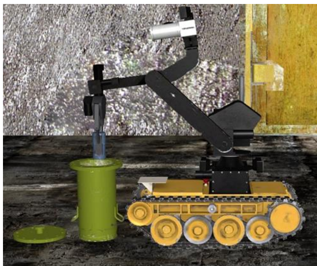
Рис. 5. Опускание радиоактивного контейнера в урну манипулятором виртуальной модели робота МФ-4
