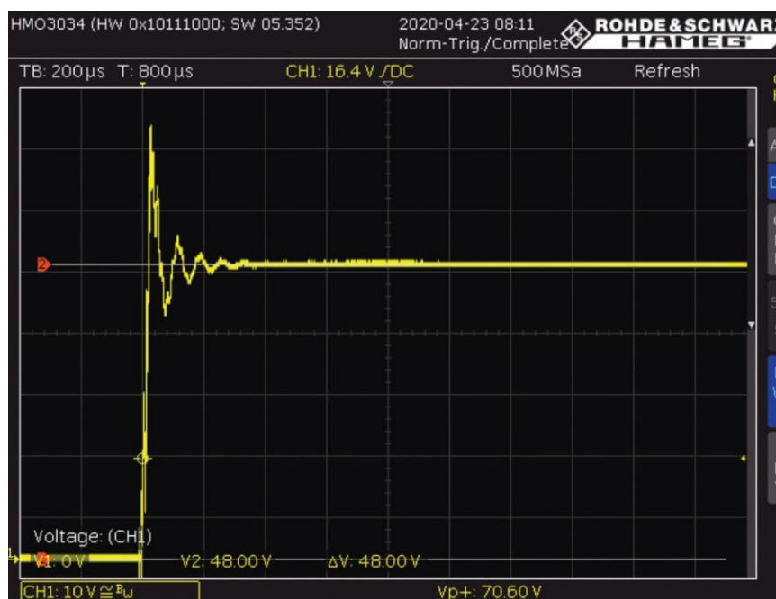
Рис. 2. Изменение напряжения на входе при подаче питания напряжением 48 В через кабель длиной 15 м [4], отражающее неустойчивость системы
