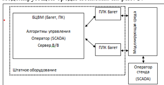
Рис. 2. Стенд полунатурного моделирования, на котором функционирует ПП ПСиЦД
