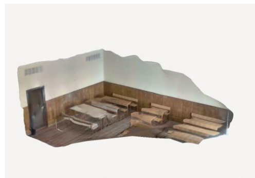
Рис. 6 3D-карта аудитории, полученная с помощью NeRF методов без постобработки
