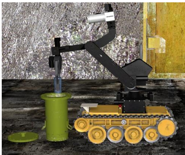
Рис. 5. Опускание радиоактивного контейнера в урну манипулятором виртуальной модели робота МФ-4
